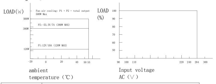
100Vac~240Vac / 47Hz~63Hz -53.5V 7.0A+12V 10A Fan air cooling 500W
